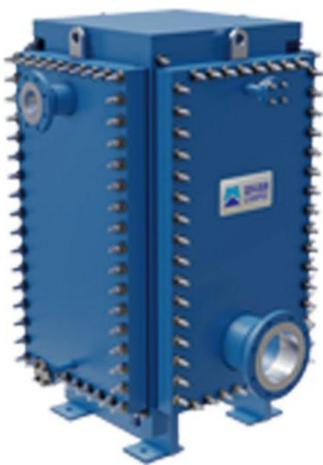
NB/T 47004.2-2021全焊接板式换热器中HC型结构，适用于两侧介质易堵塞的场合，四周盖板均可打开清洗。
